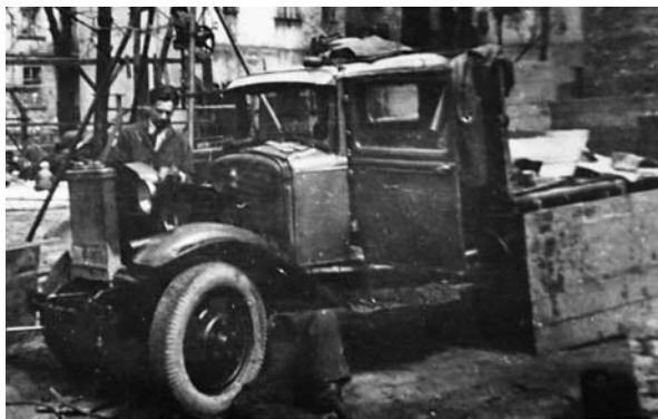
Ciężarówka Gaz (Ford) AA na napęd drzewny, którą nazywano „Pajac”.
